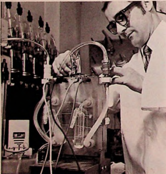
Vermogenstest aan een brandstofcel met bipolaire elektroden. (foto: AEG-Telefunken)
